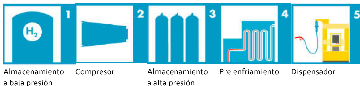
Figura 6 Módulos componentes de las estaciones de recarga de hidrógeno
