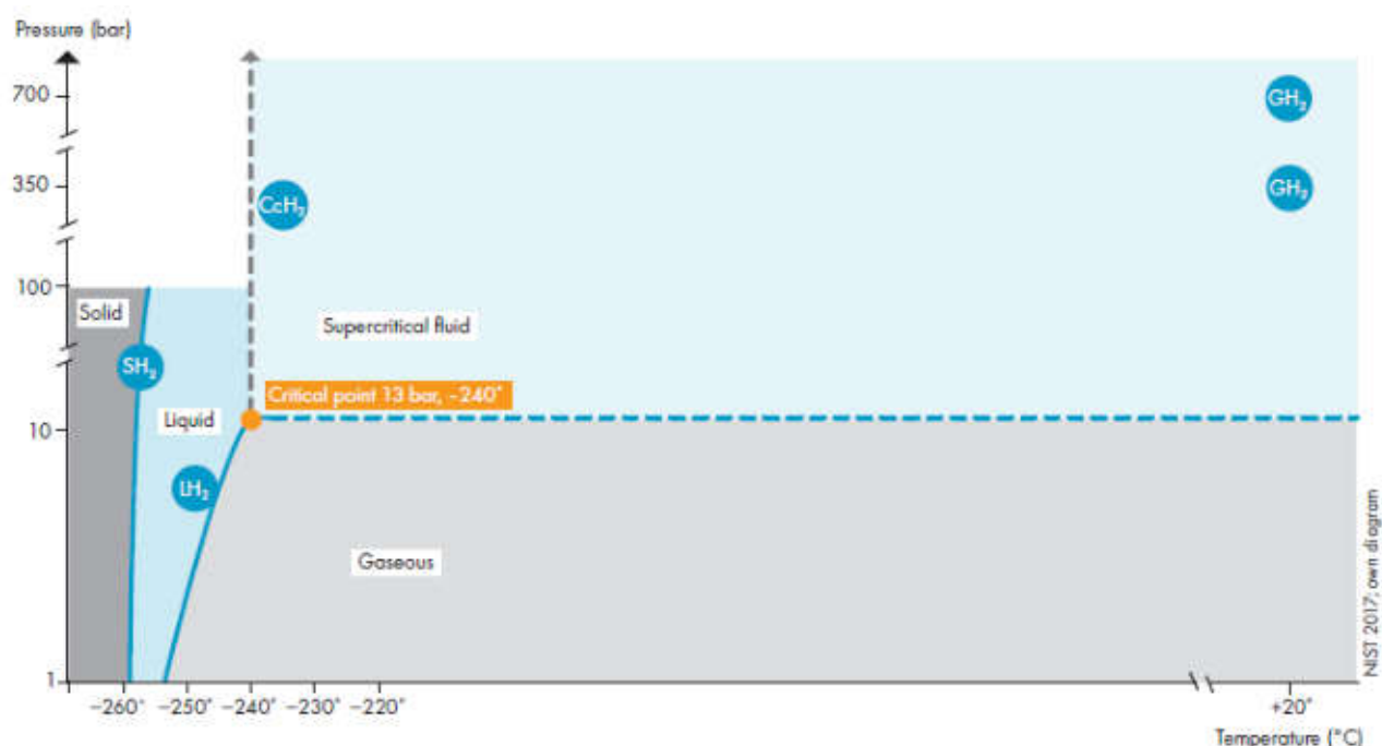
Figura 5 Diagrama de fases del hidrógeno
